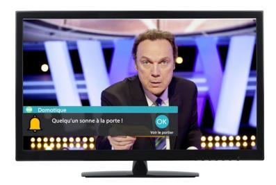
3. « <u>Alerte</u> », dans le cas d'une détection incendie, fuite d'eau, monoxyde de carbone, la Zeebox allume automatiquement la TV si elle était éteinte et va guider visuellement l'utilisateur sur la démarche à suivre face à cette alerte.
